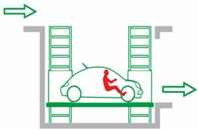
ASCENSORE PER AUTO CON SISTEMA DI ELEVAZIONE A QUATTRO COLONNE E CONDUCENTE A BORDO
