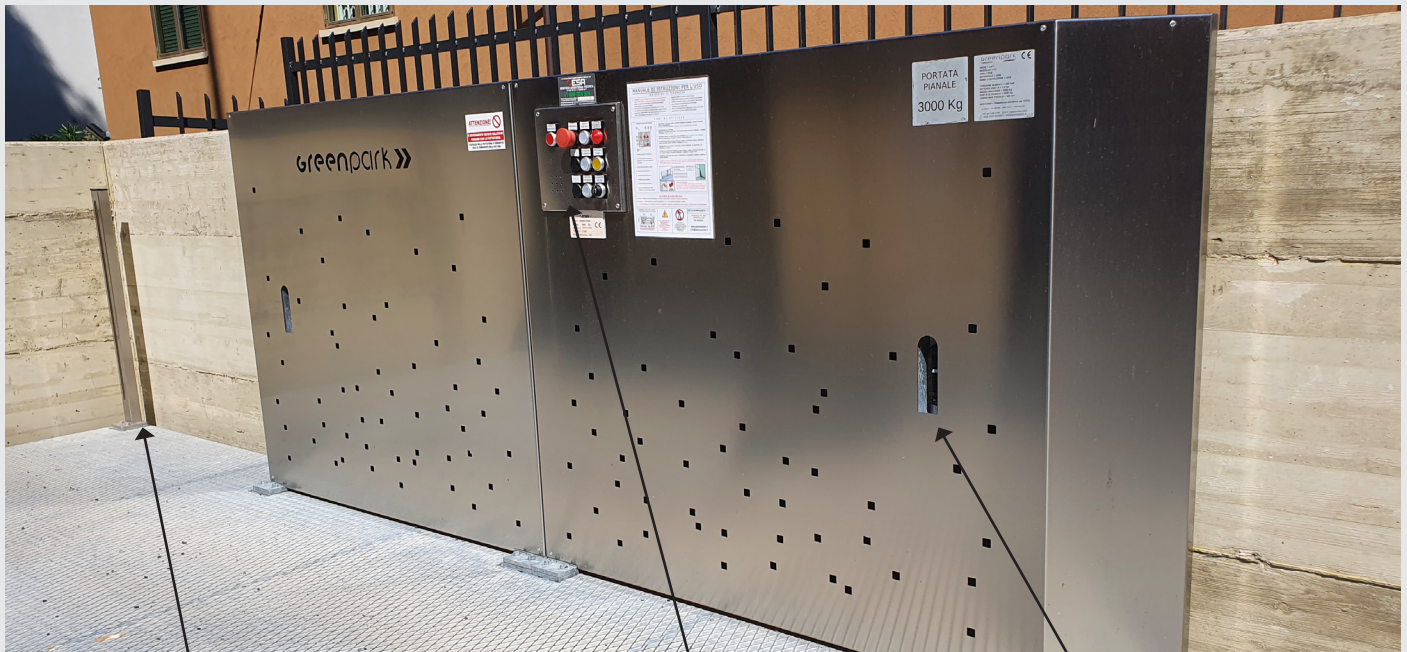
BARRIERE DI FOTOCELLULE COMPLETE DI LUCI A LED DI SEGNALEZIONE PER INDICARE IL CORRETTO POSIZIONAMENTO DELLA VETTURA
