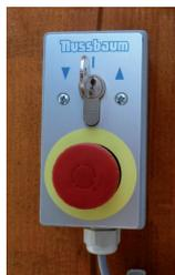
Unità di controllo dotato di selettore a chiave e interruttore di emergenza. Tutti i comandi sono del tipo „uomo presente“.
