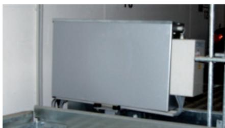
Completo di tubazioni idrauliche e interfacciata con il quadro comandi. Questo dispositivo lavora in bassa pressione e la combinazione motore-pompa è in grado di assorbire gran parte del rumore prodotto
